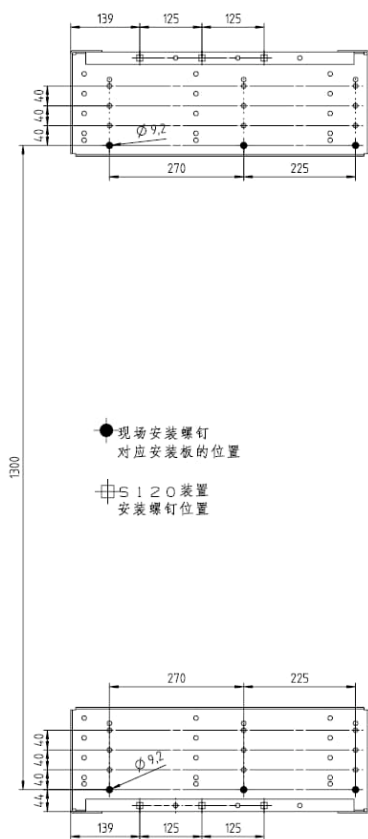
下对齐安装梁安装尺寸
